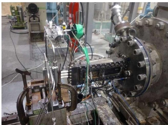
図1 楕円形プローブを用いた排ガス採取
