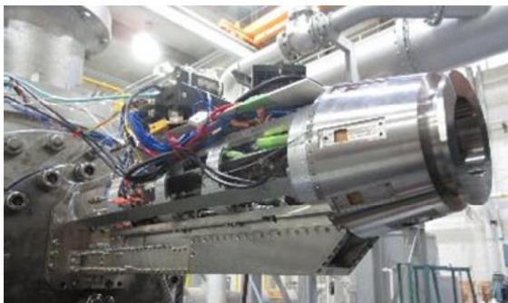
図1 ラムジェット燃焼温度制御試験装置
