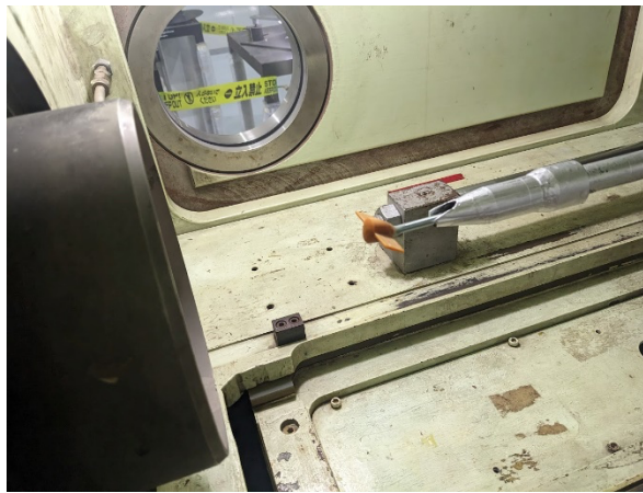
図1 実験風景 中央に模型があり、気流は左から右へと流れる
