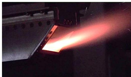
図2 燃焼中の供試体 (ノズル側)
