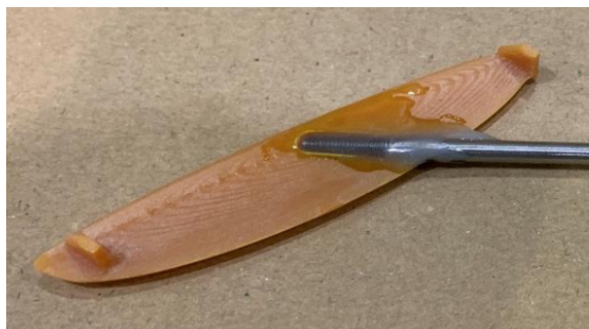
図 2 横力をキャンセルするためのフィンを有する模型の試作例
