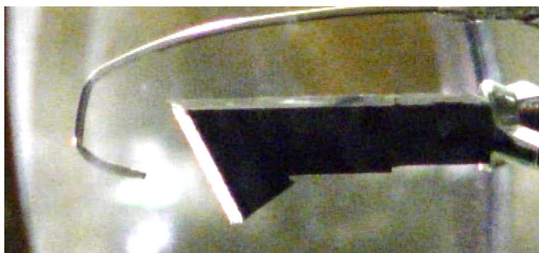
図 1 風洞測定室内においたくさび形状モデルと噴射細管
