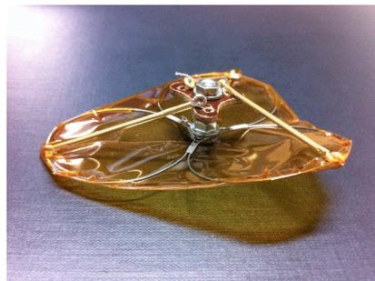
図 2 3 個のトーラスと 3 個の柱状体で構成されるデルタ翼型揚力飛行体形状のデザイン例
