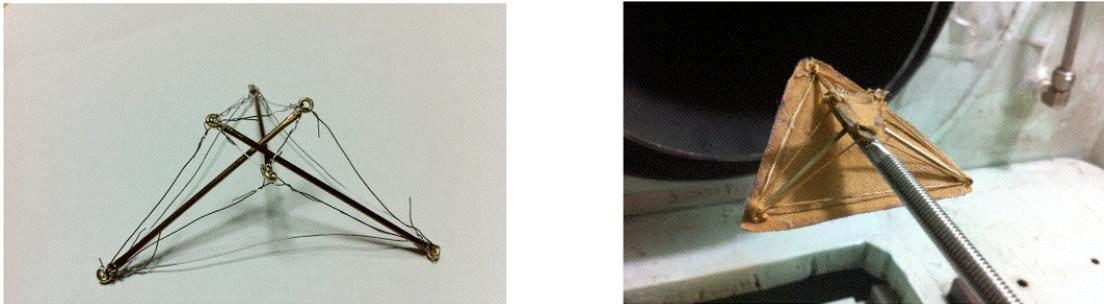
図 1 Tensegrity 構造によるデルタ翼型飛行体
