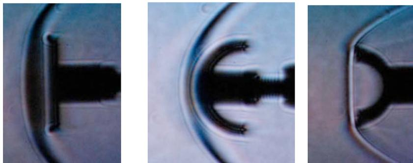
Fig. 1 各模型での衝撃波形状：平板模型（左）・凸面模型（中央）・凹面模型（右）
