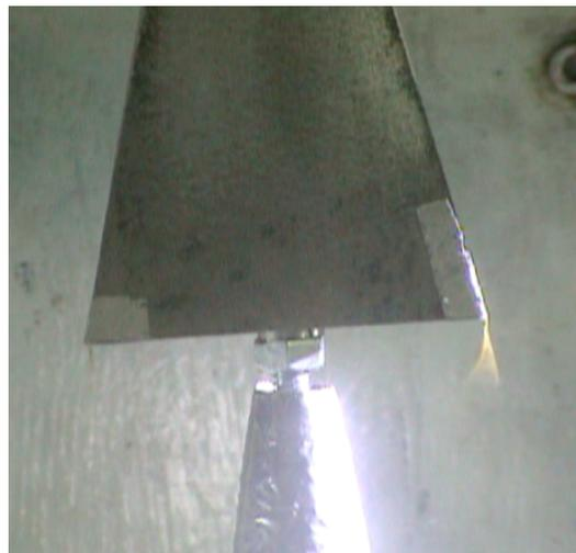
図 2 ウェイブライダー翼端で見られた翼端渦（タフト法）
