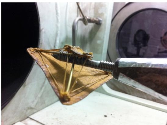
図 1 Tensegrity 構造をもつデルタ翼模型
