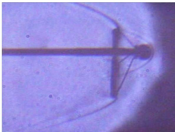
図 1 再突入機からの衝撃波とバルートとの干渉の様子
