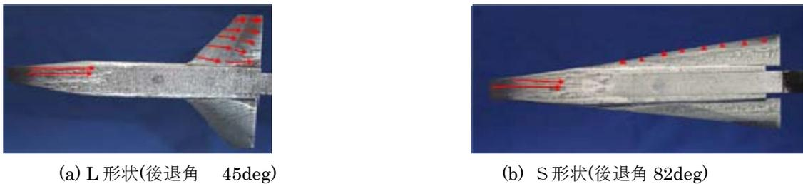
図2 オイルフロー試験 ( $\alpha = 0 \text{ deg}$ , 模型投入10秒後)
