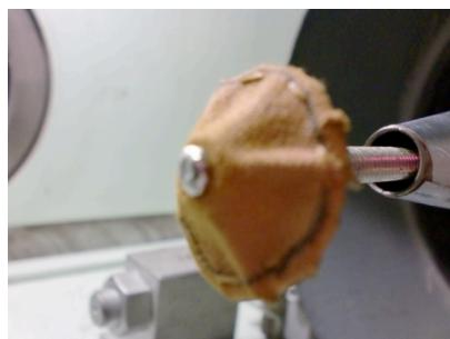
図1 円錐台フレア型模型
