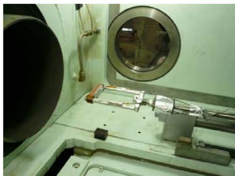
図3：インフレーター構造耐熱試験用模型
