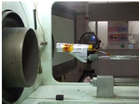
図1：膜材料の熱伝達試験用模型
