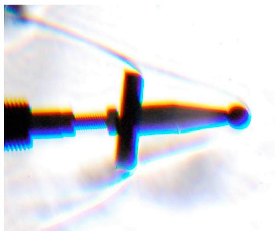
Fig. 2 シュリーレン法による再突入飛行体システムまわりの流れ場の可視化の様子
