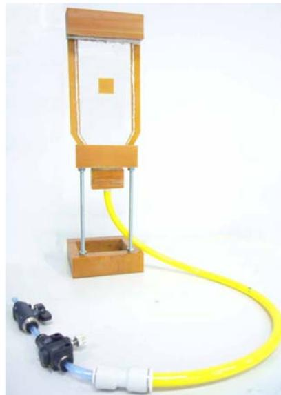
図 9 Hele-Shaw の実験装置完成図.
