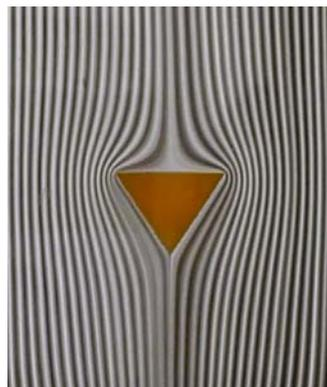
図 14 三角形（下向き）の模型周りの流れ.
