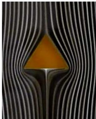
図 13 三角形（上向き）の模型周りの流れ.
