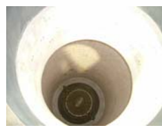
ペブルを充填する前の加熱器内部の様子(側面に耐熱レンガが、底にペブルを支えるための金網が見えます) 加熱器内部に充填されたアルミナペブル ペブルの大きさ
