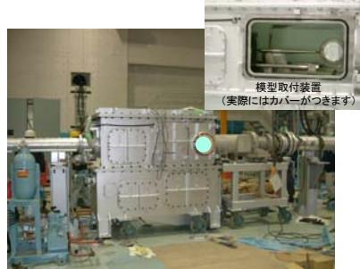
極超音速風洞測定部(気流は右から左へ、中央の円が観測窓、右側にノズルセクションが見える。)
