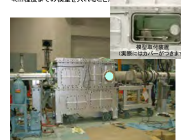
極超音速風洞測定部 (気流は右から左へ、中央の円が観測窓、右側にノズルセクションが見える。)
